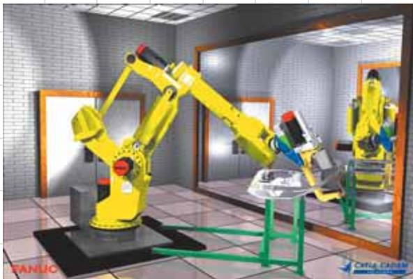
Рис. 1. Фотореалистика промышленного робота FANUC в системе CATIA
